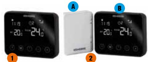
De calefacción. 250 VAC (0,25A). Intervalo de puntos de ajuste: 5°C - 35°C. Ambiente: 0°C - 50°C (incremento 0,5°C). Humedad relativa: 85%. Luz de fondo: Blanca. Se alimenta con 2 baterías AA o con cable micro USB 5V (1A). Programable para 7 días. Montaje en superficie. Homologación CE, ROHS y RED. Comunicación RF con Receptor: 868Mhz. 125 x 98 x 23,5 mm.
